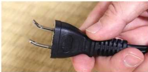
変形した電源プラグの栓刃
