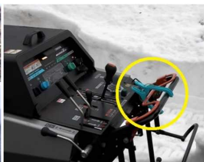
デッドマンクラッチ機構を 大きな洗濯バサミで固定
