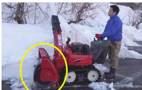
オーガ 回転部にある雪を直接砕いて 集めらせん状の刃部分
