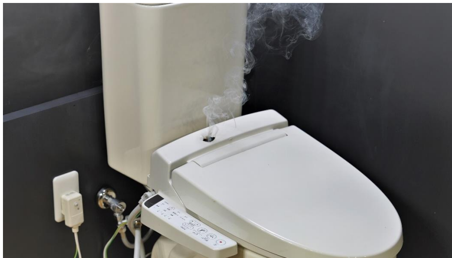
撮影協力：一般社団法人日本レストルーム工業会 経年劣化による漏水で発火し、焼損した温水洗浄便座（再現実験）
