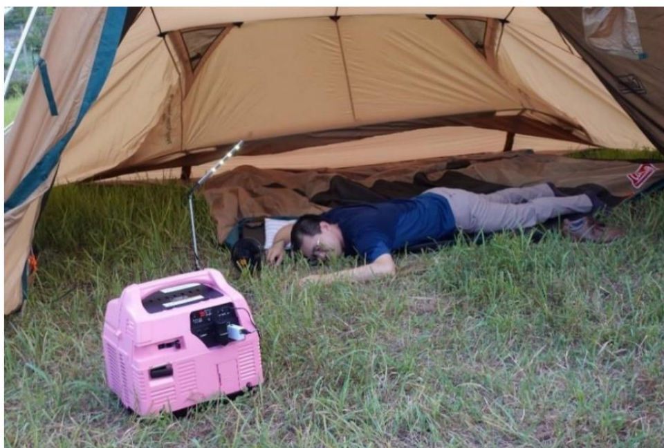
一酸化炭素中毒事故のイメージ (テント入口で携帯発電機を使用)
