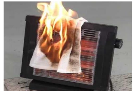
電気ストーブに 洗濯物が落下して発火
