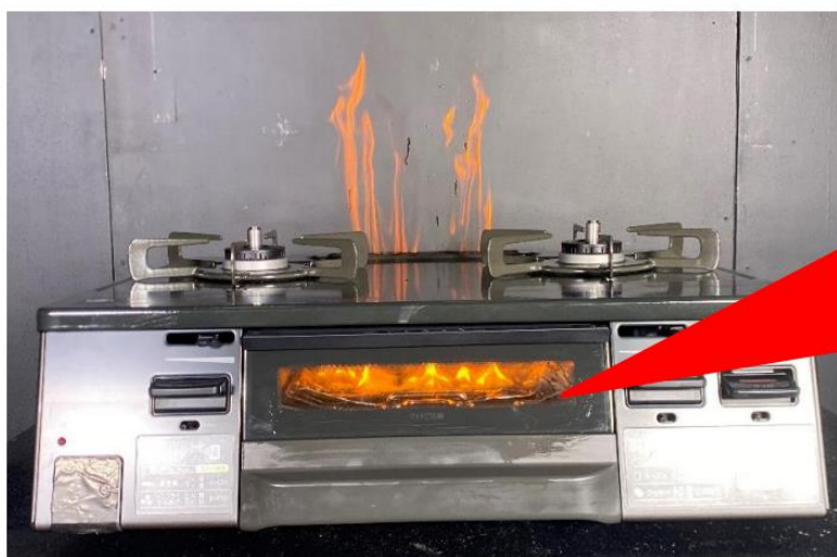
グリル庫内から発火している様子
