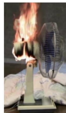
内部部品の経年劣化により発火する扇風機の再現映像
