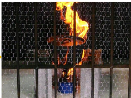
過熱されたボンベの接続部から漏れたガスに引火した様子
