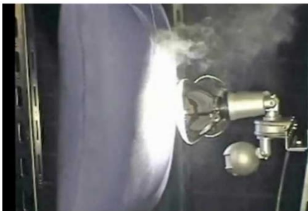
照明器具による火災 (電球に近づけた布が発煙)
