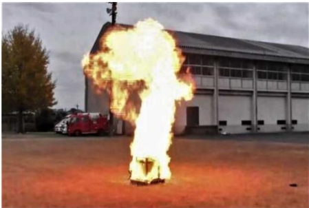
カセットボンベが破裂し引火 (撮影協力：群馬県消防学校)
