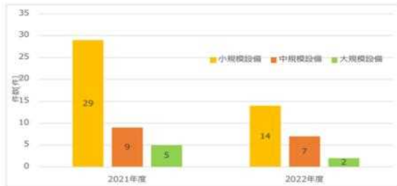
【図3】 積雪による太陽電池発電設備の破損事故件数
