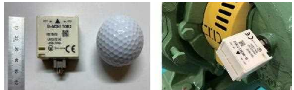
小型無線式センサの外観（左）とポンプにセンサを設置した状態（右）
