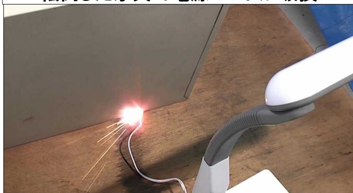
転倒した家具で電源コードが破損
