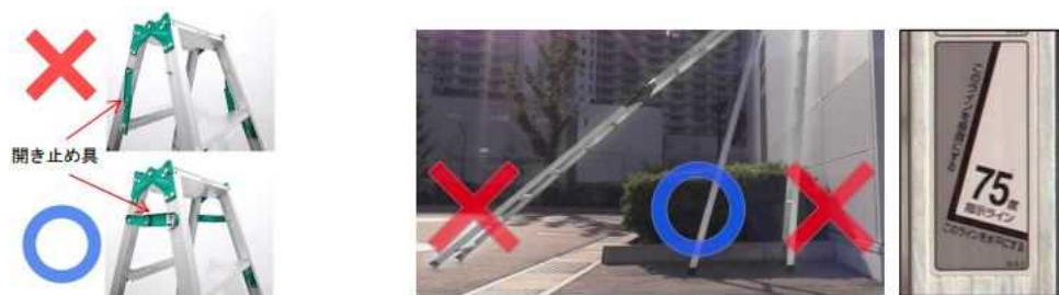
開き止め具のロック はしごの立てかけ角度と 75 度の角度指示ラベル例
