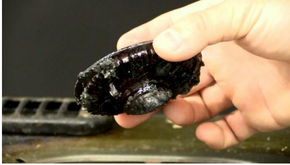
バーナーキャップの炎口が汚れて詰まっている様子
