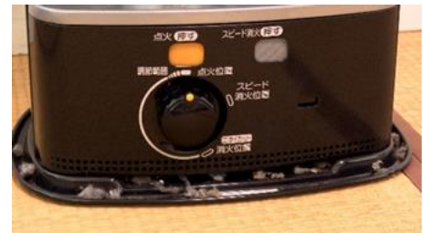
(掃除不足の例) 置台にたまったほこり
