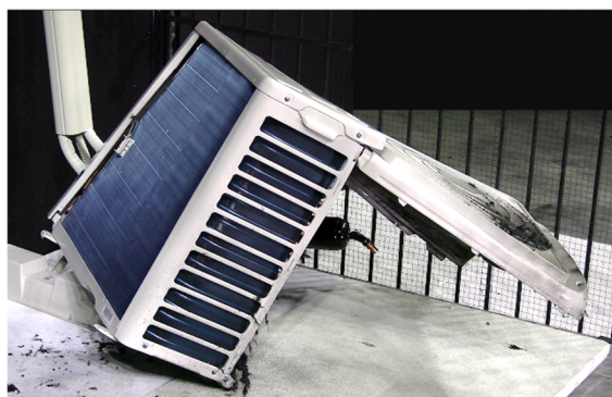
「無謀なDIY」による室外機の破裂
