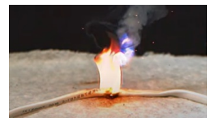
電源コード断線部から発火
