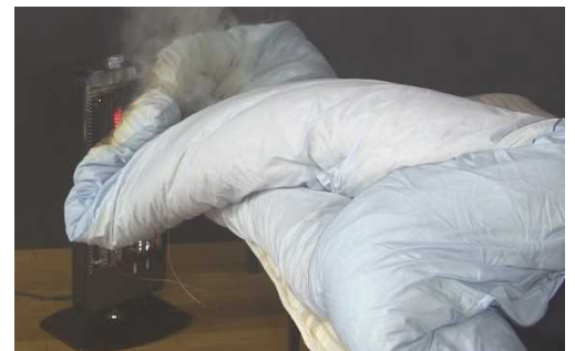
電気ストーブと寝具の接触
