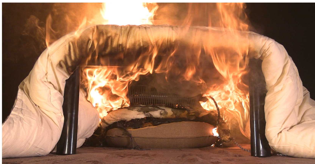
こたつのヒーターユニットにふとんが接触して発火
