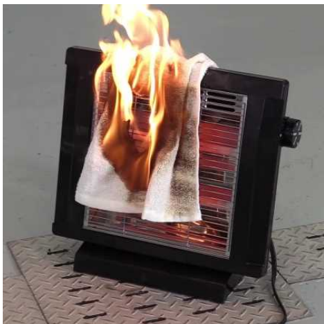
電気ストーブに可燃物が接触して発火
