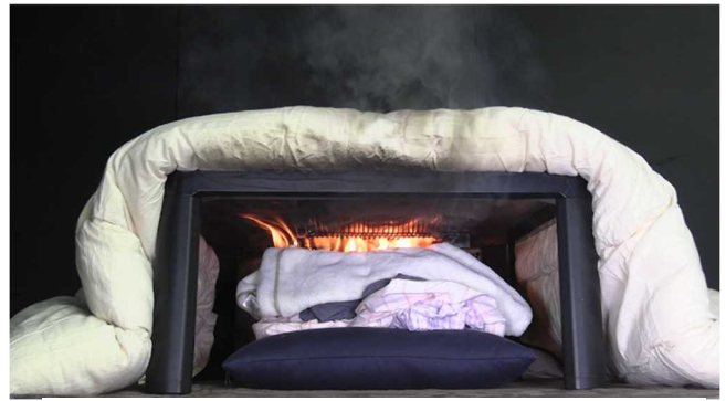
洗濯物がヒーターユニットに接触して発火
