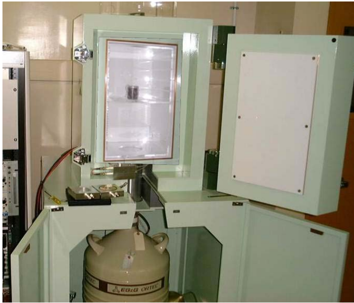
ゲルマニウム半導体検出器で土壌の測定
