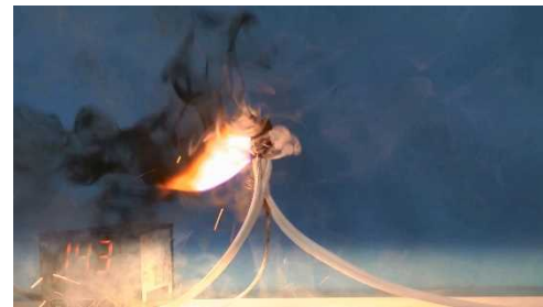
電源コードのねじり接続部から発火
