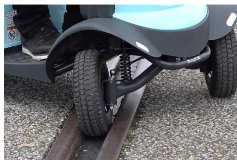
前輪が線路の溝に挟まっている様子
