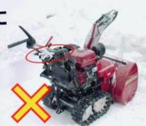
安全装置 (フットマンクラッチ機構) を無効化した例
