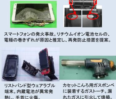
スマートフォンの発火事故。リチウムイオン電池セルの、電極の巻きずれが原因と推定し、再発防止措置を提案。
