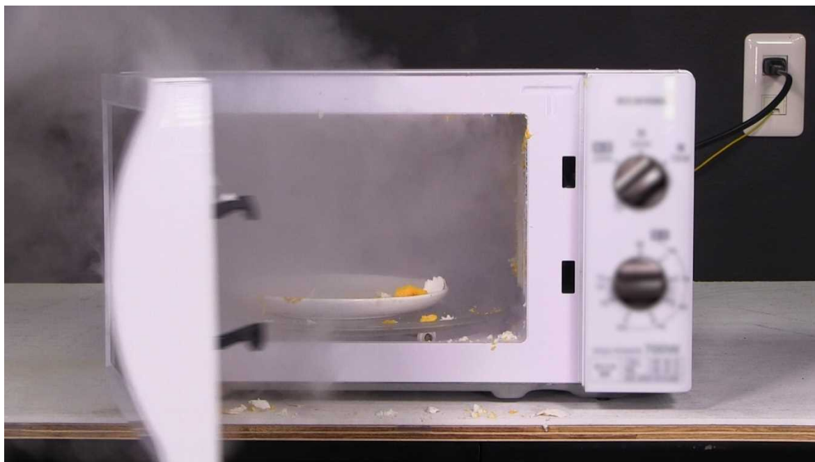
(写真) ゆで卵の破裂により扉が開く様子
