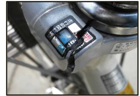
ケース破損状態
