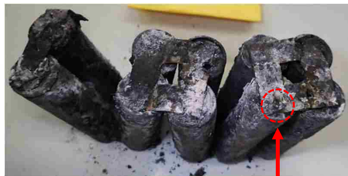
電圧監視線の痕跡あり
