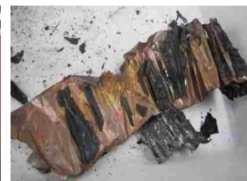
LIBセルの熱暴走イメージ 引用元：JIS C 8715-2 リチウムイオン電池の安全性と要素技術 髙島真一，科学情報出版株式会社，P38
