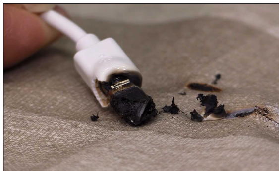
充電ケーブルの接続部が焼損している様子 ※実際に事故の発生した製品ではありません
