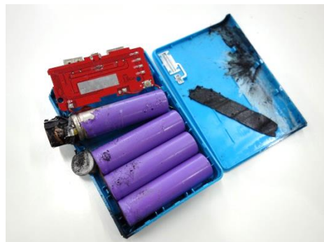
(写真) 焼損したモバイルバッテリー
