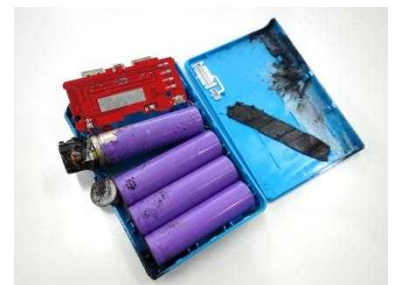
モバイルバッテリーの事故品
