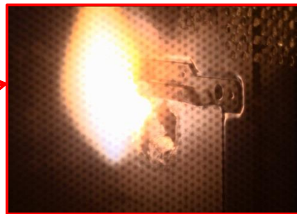
(写真) 電子レンジの庫内に付着した汚れが炭化して発火
