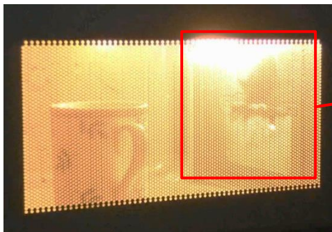
(写真) 電子レンジの庫内に付着した汚れが炭化して発火
