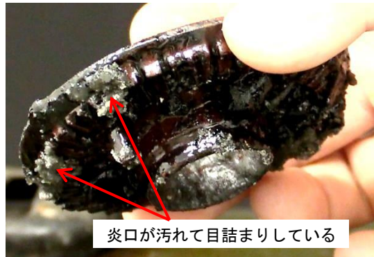
(写真)バーナーキャップの炎口が目詰まりしている様子（イメージ）
