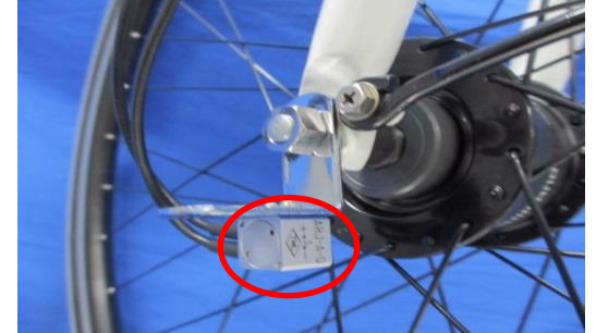
2軸加速度センサ (水平、鉛直加速度を同時測定)
