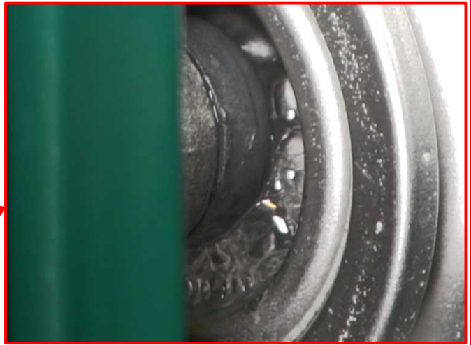
(写真) カセットボンベ式ガストーブとボンベの隙間からガスが漏れている様子 (イメージ)
