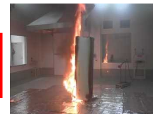
大型冷蔵庫の事故再現実験(大型燃焼実験室)
