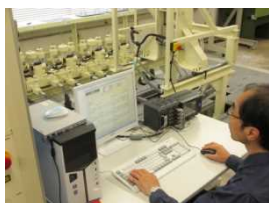
自転車フレームの実走行再現試験(4軸振動試験装置)
