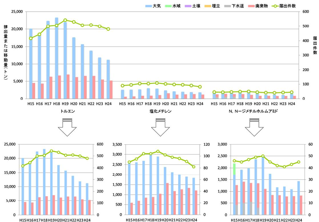
図2-23 排出量・移動量の24年度上位物質の推移(プラスチック製品製造業)
