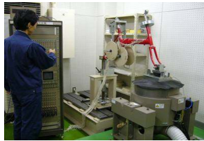
自転車フレーム耐振性試験
