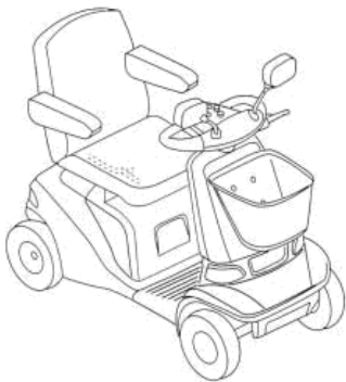
図10 ハンドル形電動車いす 主に高齢者が使用することが多い。
