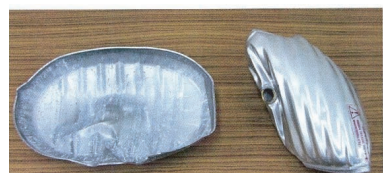
実際に破裂した事故品の金属製ゆたんぽ
