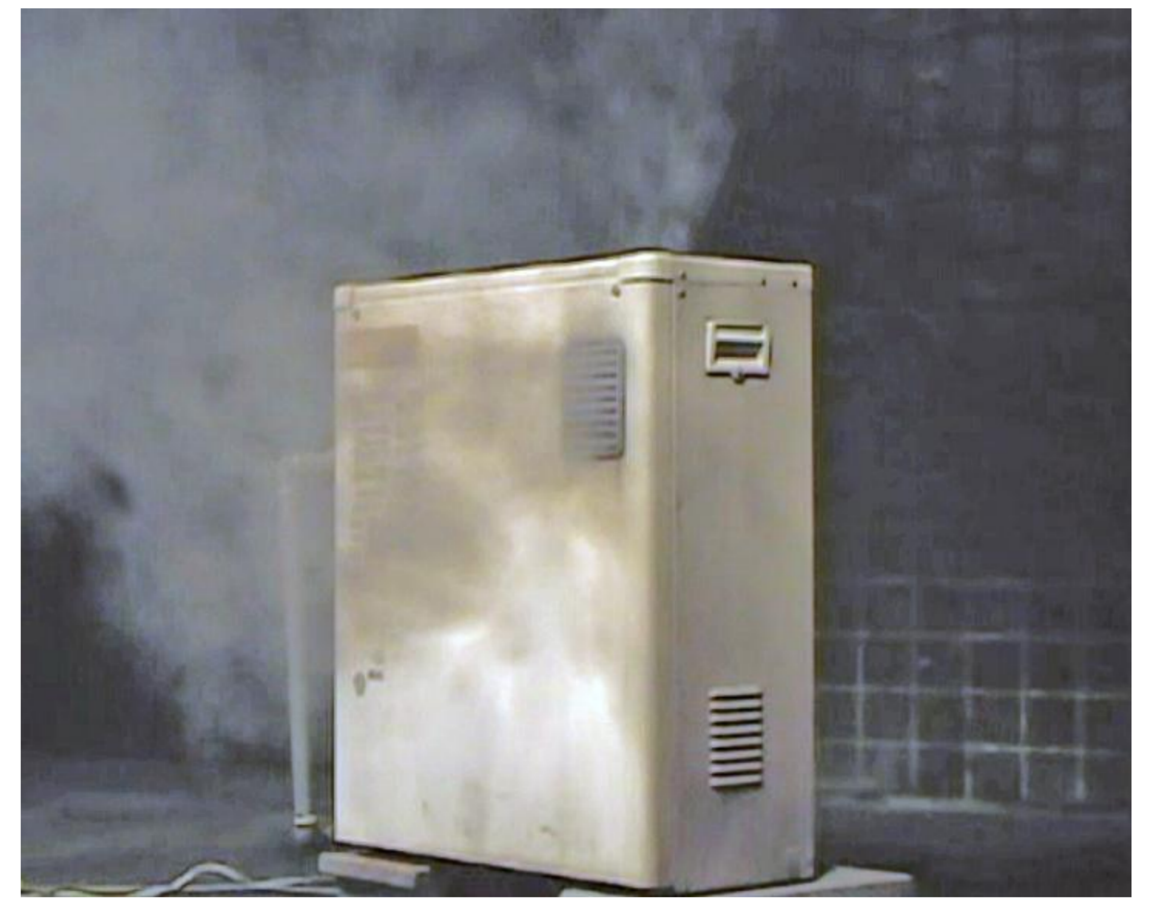
石油給湯機のOリングが劣化し、器具内に漏れた灯油に引火した事故を再現実験
