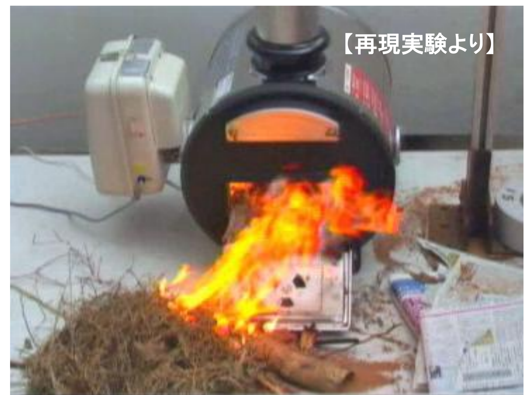
まき兼用ふろがまの近くに 枯れ葉を置いた再現実験
