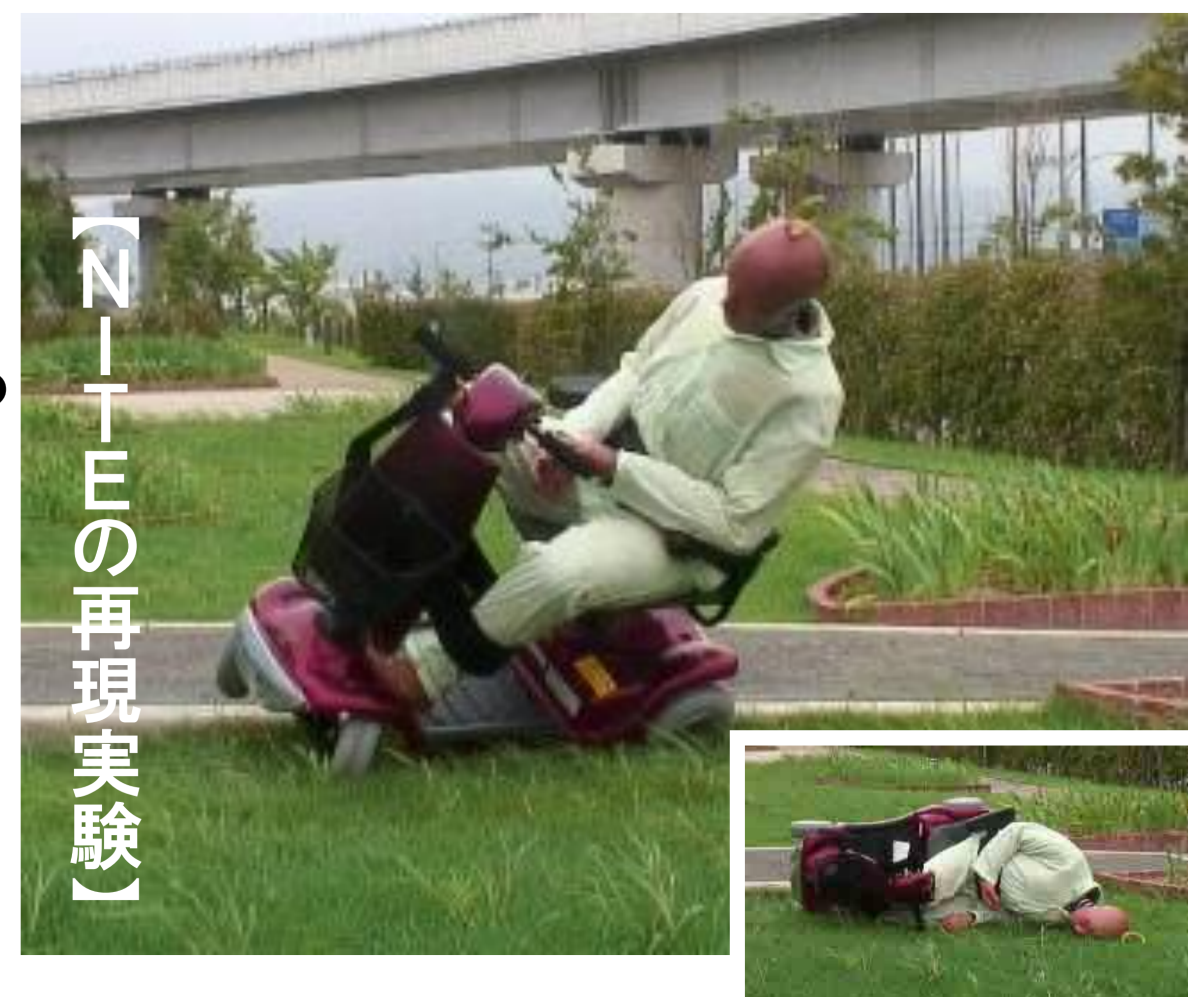
路肩から脱輪して転倒しました
