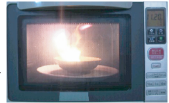
再現実験 温めた里いもが過熱により発火した(NITEの)
