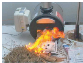
まき兼用ふろがまの近くに枯れ葉に引火しました。(再現実験より)
