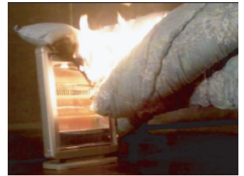
ストーブに触れたふとんに着火しました。(再現実験より)
