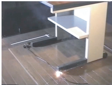
机の下敷きになった電源コードから発火 (NITE再現実験)
