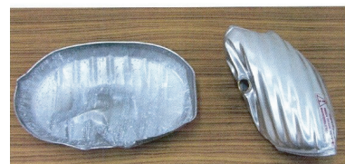
実際に破裂した事故品の金属製ゆたんぽ
