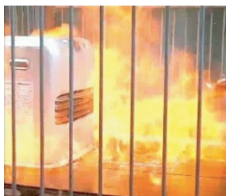
スプレー缶をファンヒーターの前に置いていたところ、熱で膨張して噴き出したガスに引火しました。(再現実験)
