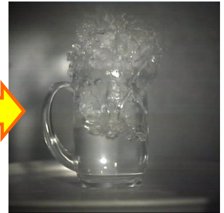
大きくなった 蒸気の泡が液 体（水）の表 面に達した瞬 間に破裂、液 体が周辺に激 しく飛び散る
