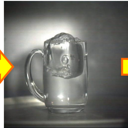
発生した蒸気 の泡が大きくな りながら表 面に上昇
