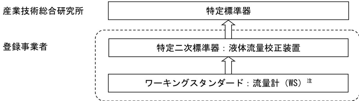
2. 液体流量校正装置 (組立 WS) の場合
