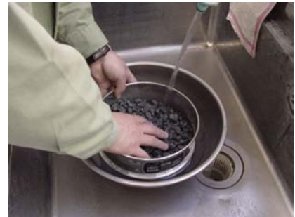
写真 3.3.1 試験試料の水洗いの状況
